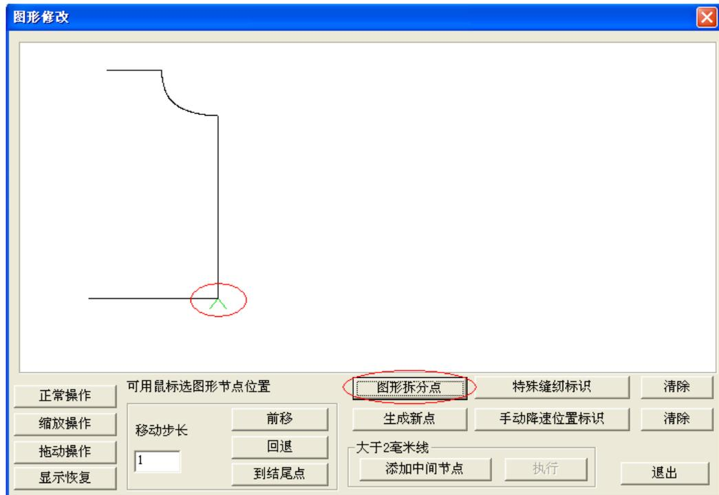
点击“图形拆分点”，则图形从拆分点处被拆分为两个图形，如下图所示：
