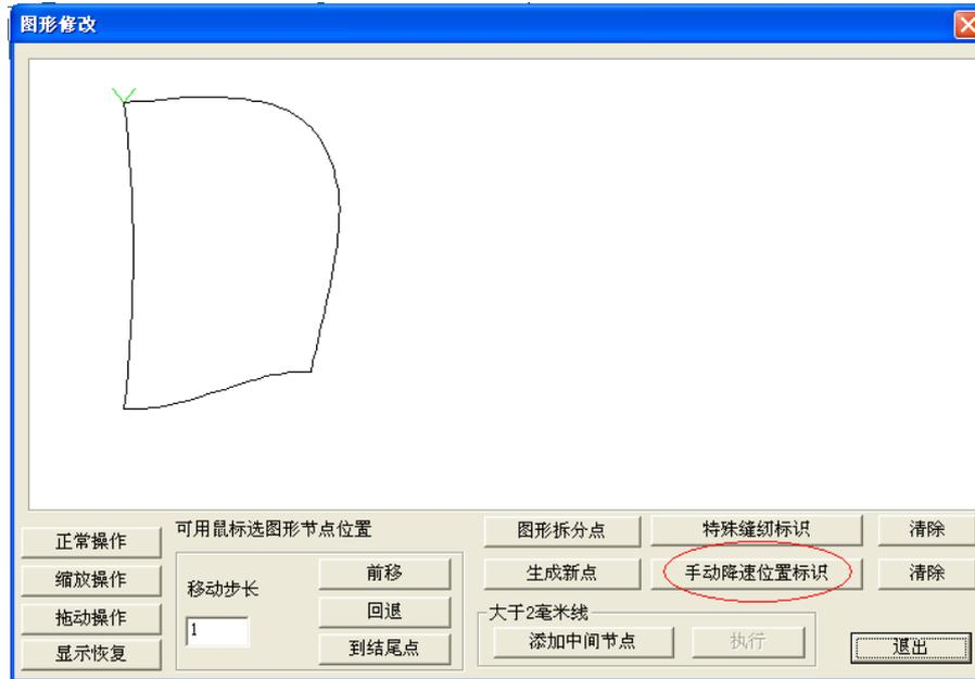
用鼠标双击图形上“降速点1”的点位，点击“手动降速位置标识”即可，如下图所示：
