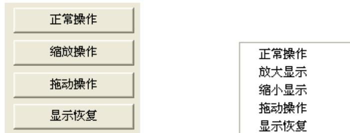
**放大显示：**点击工具栏的“缩放操作”按钮或绘图区[右键单击->放大显示]，当鼠标变为
