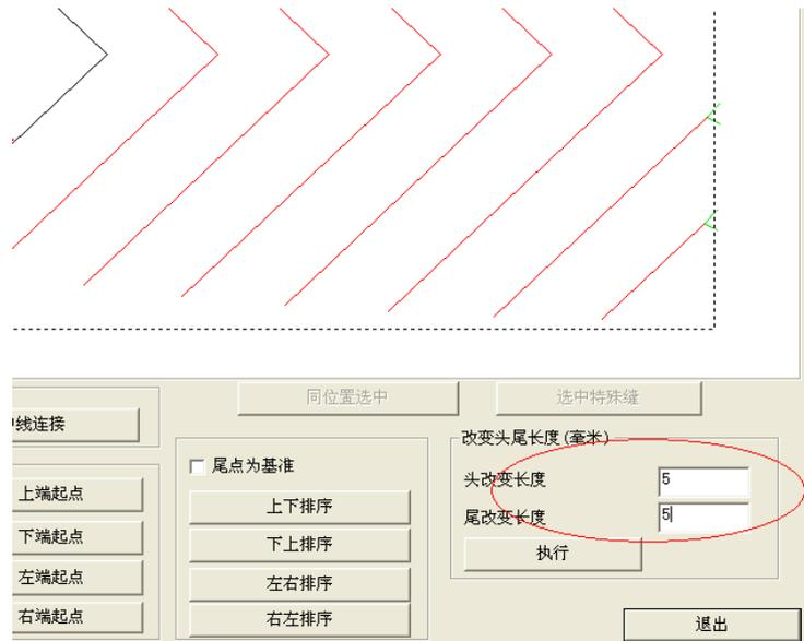
选中需要延长或者缩短的图形，在“改变头尾长度”的编辑框中，输入头尾改变长度的数值，点击“执行”，则图形延长或者缩短。
