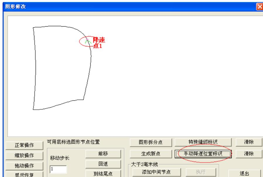
设置后，在“输出指令”中可以看到，当接近手动降速位置时有了“拐点提前减速” - “拐点位置” - “拐点后加速完成” 指令。
