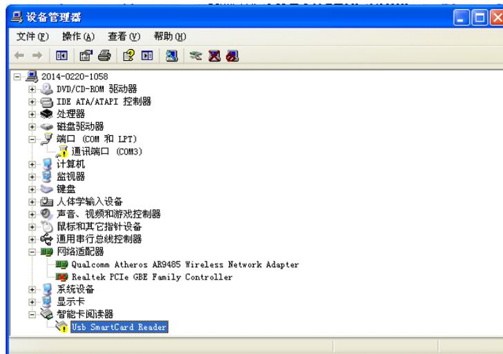
若在“智能卡阅读器”下有黄色感叹号，如
