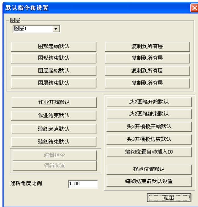
【图形起始默认】：此处为针对所选定的图层里，在执行每个图形前所需要执行的指令
