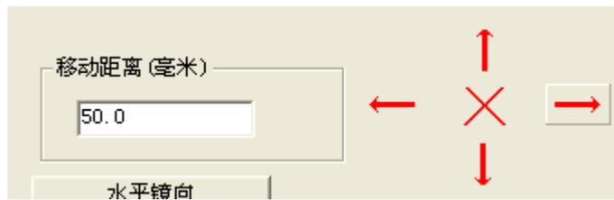
注：若是图形左移或上移，移动到图形中有小于 0 的坐标，则软件会自动调整坐标原点，以整体图形外接矩形左上角坐标为原点。
