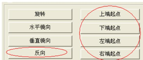
点击“反向”按钮可使所选图形起点反向，即交换起点和终点，交换后的图形如下图（左）所示。
