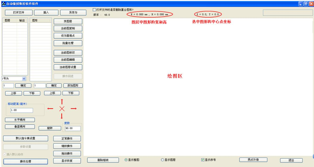
注：图层中图形的宽和高：“宽”指图层中所有图形从最左端点到最右端点在水平（X轴）方向的长度。“高”为从最上端点到最下端点在垂直（Y轴）方向的长度。
