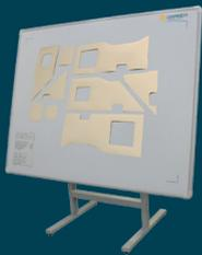
将已有样板放在读图板表面，读取周边线和内部线条
