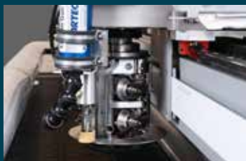
选配涡轮刀具冷却装置防止面料层裁剪中出现熔边现象。
