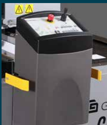
急停按钮和横梁防护挡板确保操作工人的人身安全。
